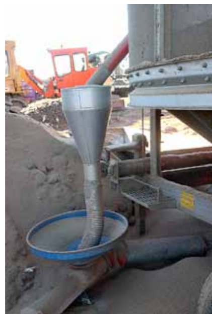
STØVAVSUG: På senterskruen sitter det et støvavsug som fjerner store partikler som halm og ugrasfrø, mens det på toppen av mobiltørka sitter et støvavsug som fjerner små partikler.
