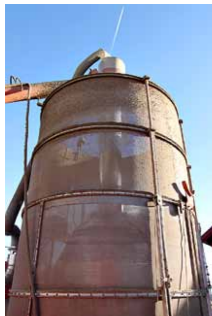
PERFORERT: Om Opland fyller mobiltørka med 12 tonn korn med en fuktighet på 25 prosent, er det over ett tonn vann som skal dampes ut. At mobiltørka er perforert hele veien rundt, i tillegg til at den står i fri-luft, gjør det enkelt for vannet å unnslipe.
